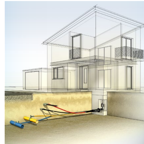
Gebäude mit Keller: Mehrspartenhauseinführung durch die Kellerwand
