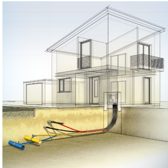
Gebäude ohne Keller: Mehrspartenhauseinführung durch die Bodenplatte
